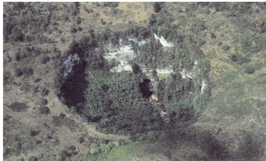
Figura 3-2. Vista aérea del sumidero Tres Pueblos, este sumidero es el resultado de un proceso de erosión de la caliza, de textura y pureza localmente distinta (USGS, 1990).
