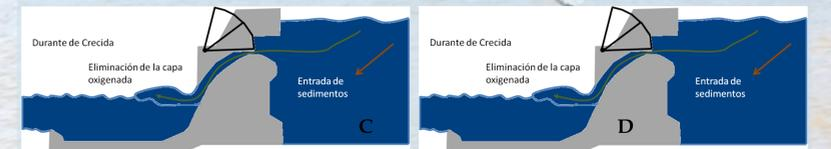
(C) La capa oxigenada se pierde del embalse con la apertura de las compuertas y gran cantidad de sedimentos entra en el embalse. (D) La estratificación de oxígeno cambia. Los niveles de oxígeno a nivel de superficie son bajos y la turbidez aumentó.
