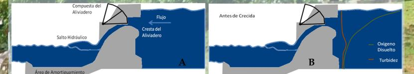
(A) Estructura básica del embalse La Plata. (B) Condiciones del embalse antes de las crecidas: estratificación de oxígeno siendo mayor en la superficie. La turbidez es bastante homogénea a lo largo de la columna de agua.
