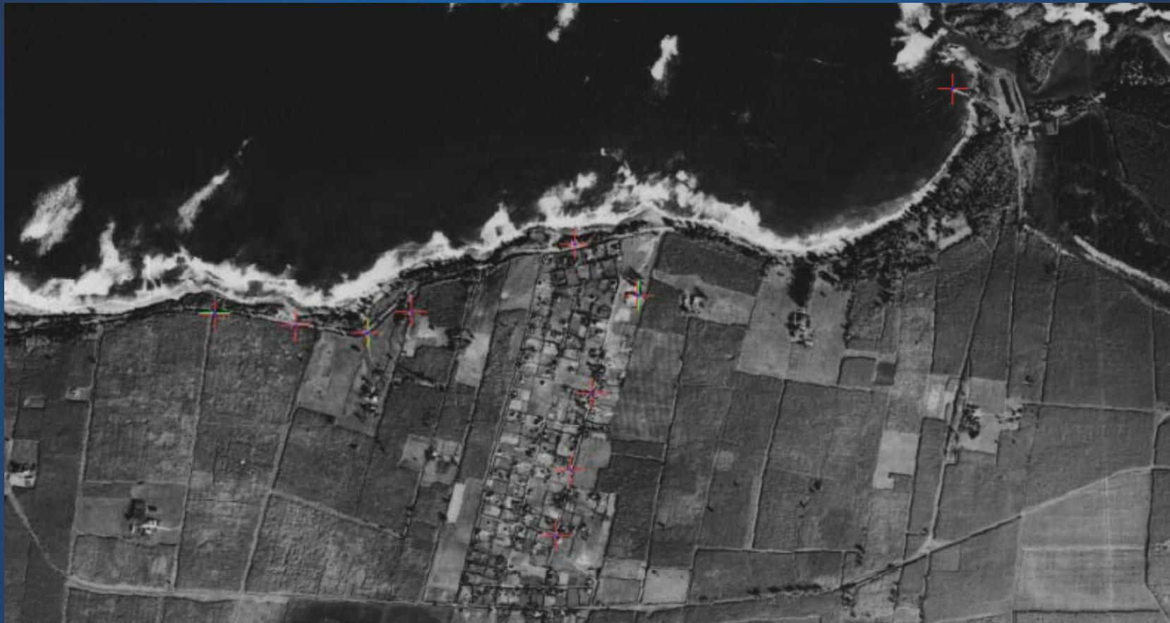
Georreferenciación de imágenes del 1950, 1987, 2000 y 2006 a coordenadas planas NAD83 PRVI utilizando Arc Map. Fuente: DTOP.
